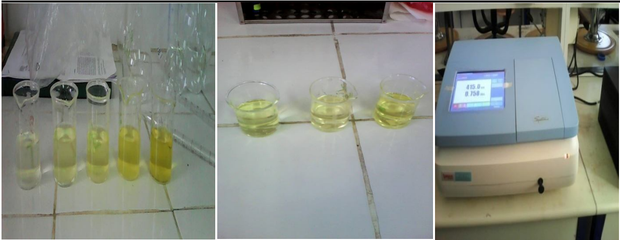
Figure 3-11: Le mode opératoire pour le dosage des nitrates par la méthode spectroscopique.
