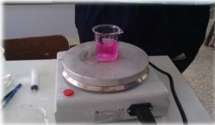
Figure 21 : coloration avant virage de l'indicateur coloré (Murexide)
