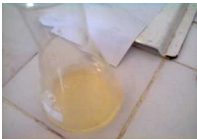
Figure 23 : virage à la Couleur jaune indicatrice de la présence de Nitrates
