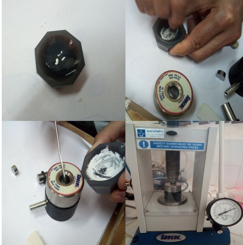
Figure IV-4 : Etapes d'obtention des pastille.
