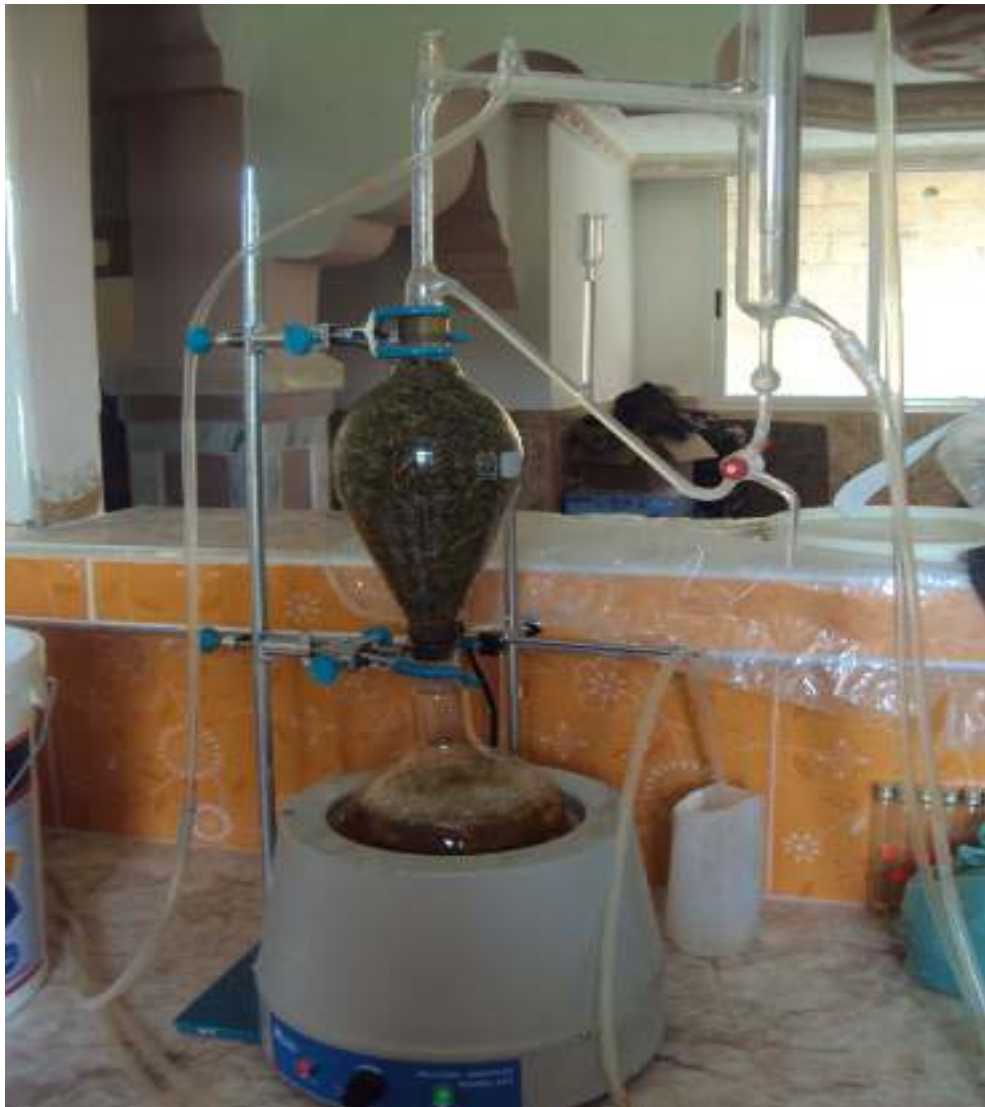
Figure 5 : Montage de la distillation par entraînement à la vapeur d'eau (clevenger).
