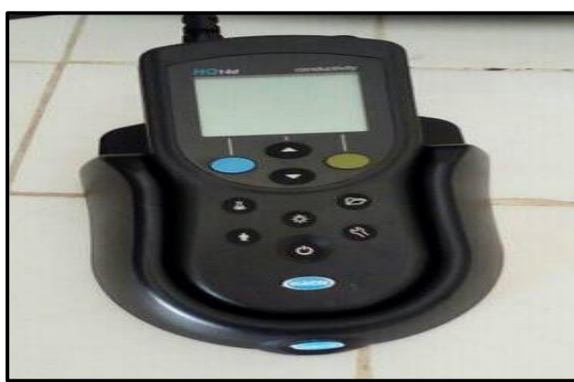
Figure 15. Le conductimètre utilisé pour la mesure de la CE.
