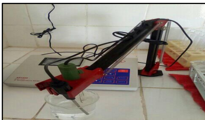
Figure 14. Le ph mètre utilisé pour la mesure du pH.
