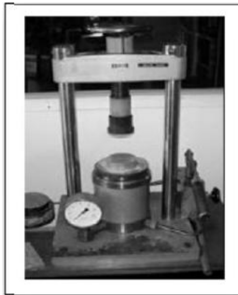
Figure I. 4 : Presse hydrostatique utilisée pour la préparation des pastilles [7].
