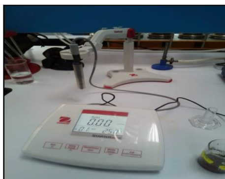
Figure 4 : Mesure de la conductivité électrique après agitation des échantillons (27/04/2023)
