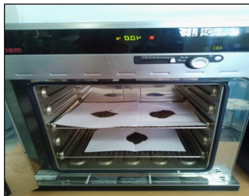
Figure 5 : Séchage des échantillons de composts à l'étuve (27/04/2023)
