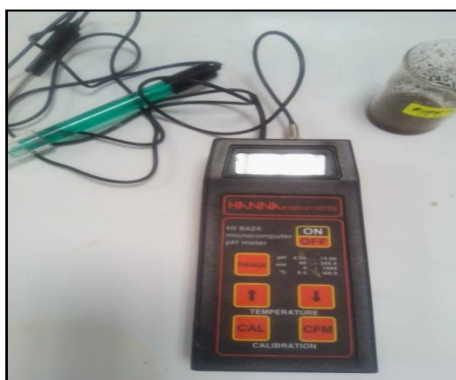
Figure 3: Mesure du pH des échantillons de composts (27/04/2023)
