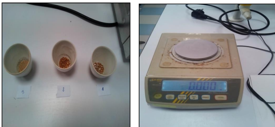
Figure 6 : Pesée des échantillons après séchage à l'étuve (14/05/2023)
