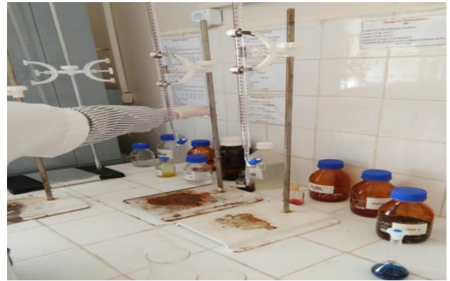
Fig. 27 : Le dispositif de dosage titrimétrique (photo personnelle 2019).
