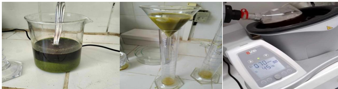
Figure 4. Préparation de l'extrait hydrométhanolique (A- Macération 24h ; B- Filtration ; C-Evaporation au Rotavapeur (45°C)).
