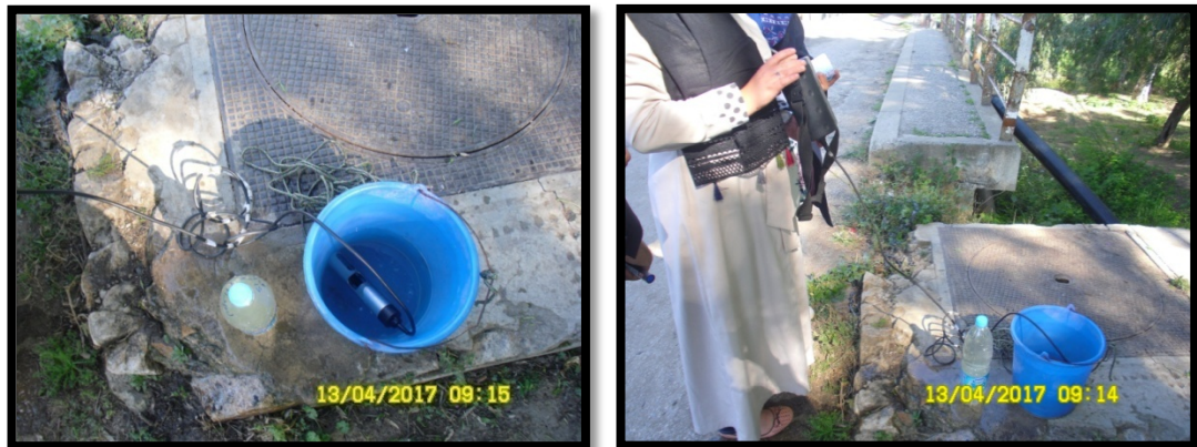
Figure 22: Mesure des paramètres physiques par multiparamètre 1970i
