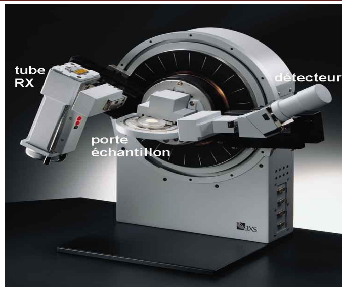
Fig.28: Principe de fonctionnement d'un diffractomètre
