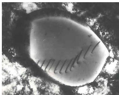
Fig.43: Image (MET) montre des dislocations
