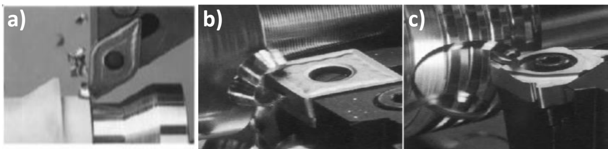
Figure I-18 : a) Opérations de contournage. b) travail d'enveloppe. c) travail de forme. [3]
