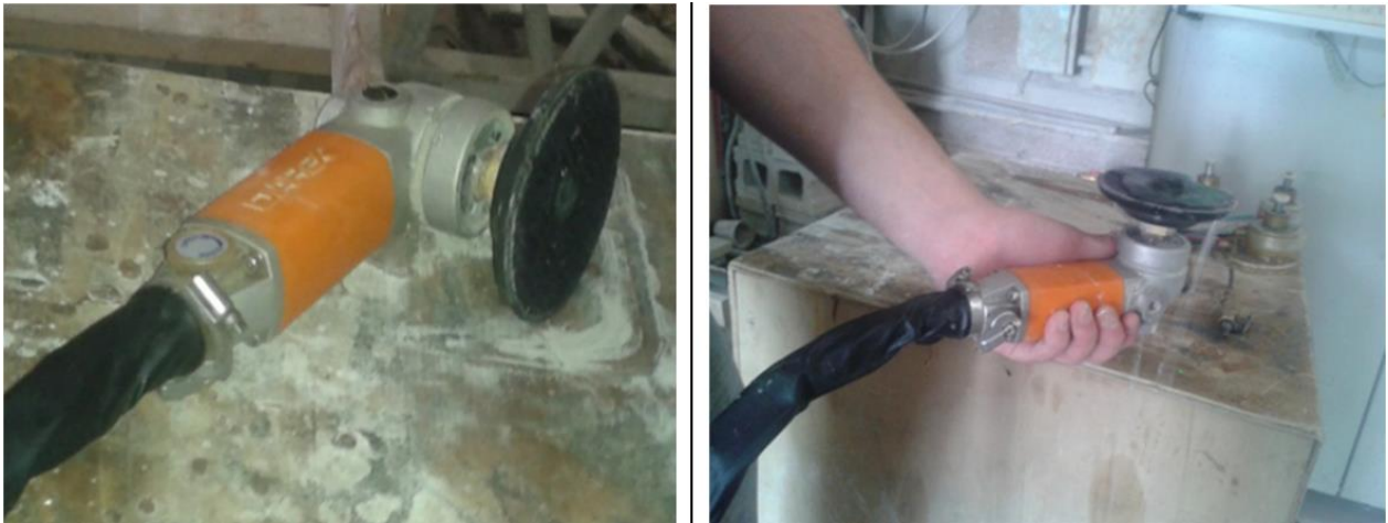
Figure I-15 : Outil pneumatique pour le polissage manuel. [18]
