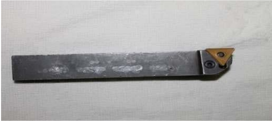
Figure II-3 : Outil à charioter utilisé pour l'ébauche.
