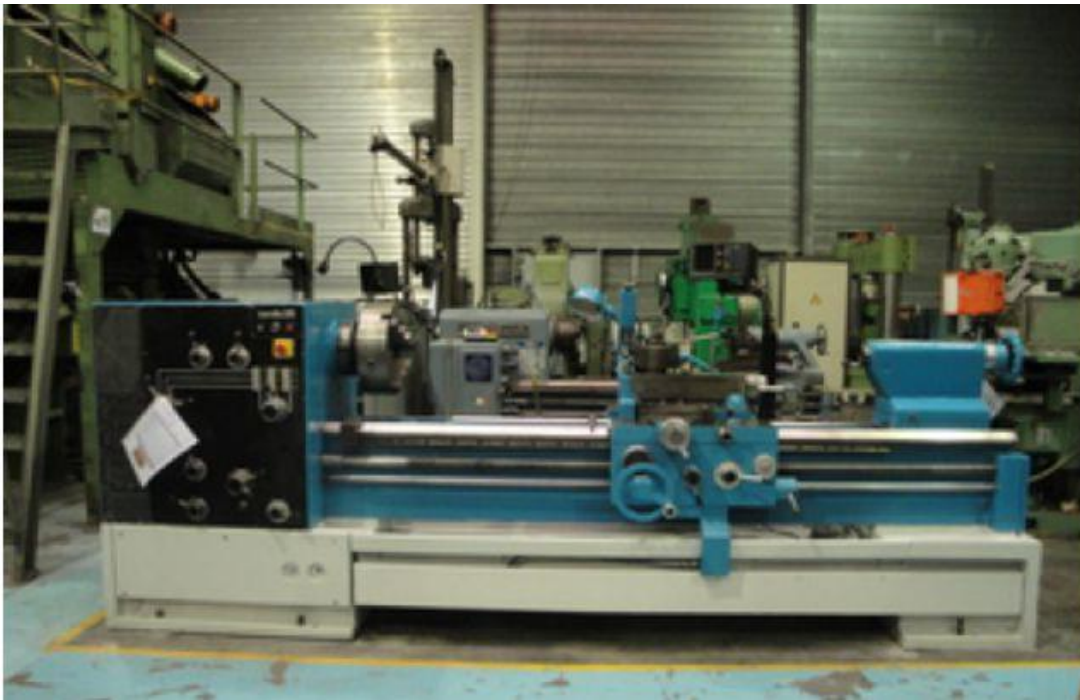
Figure II-4 : Machine d'essai ; une tour parallèle MULLER ET PESANT
