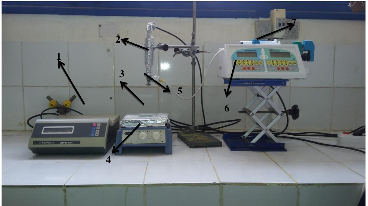
Figure II. 6 Dispositif de dépôt de couches minces par spray pyrolyse ultrasonique
