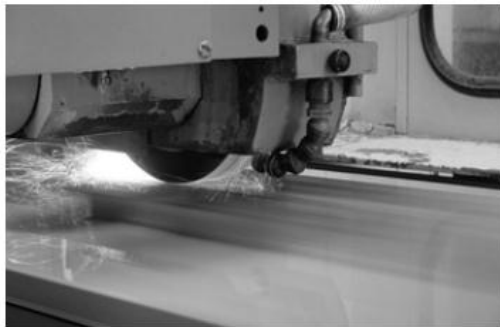
Rectification d'une surface plane
