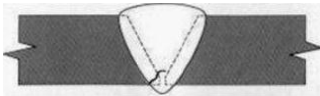
Fig.V.8. Fissure de Racine.
