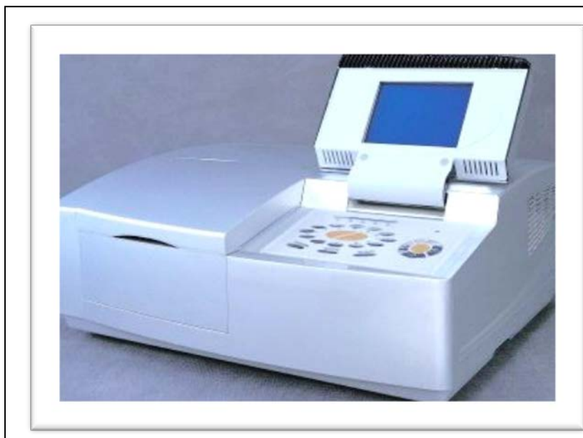
Figure II.4. La spectrométrie U SpectroScan 80D
