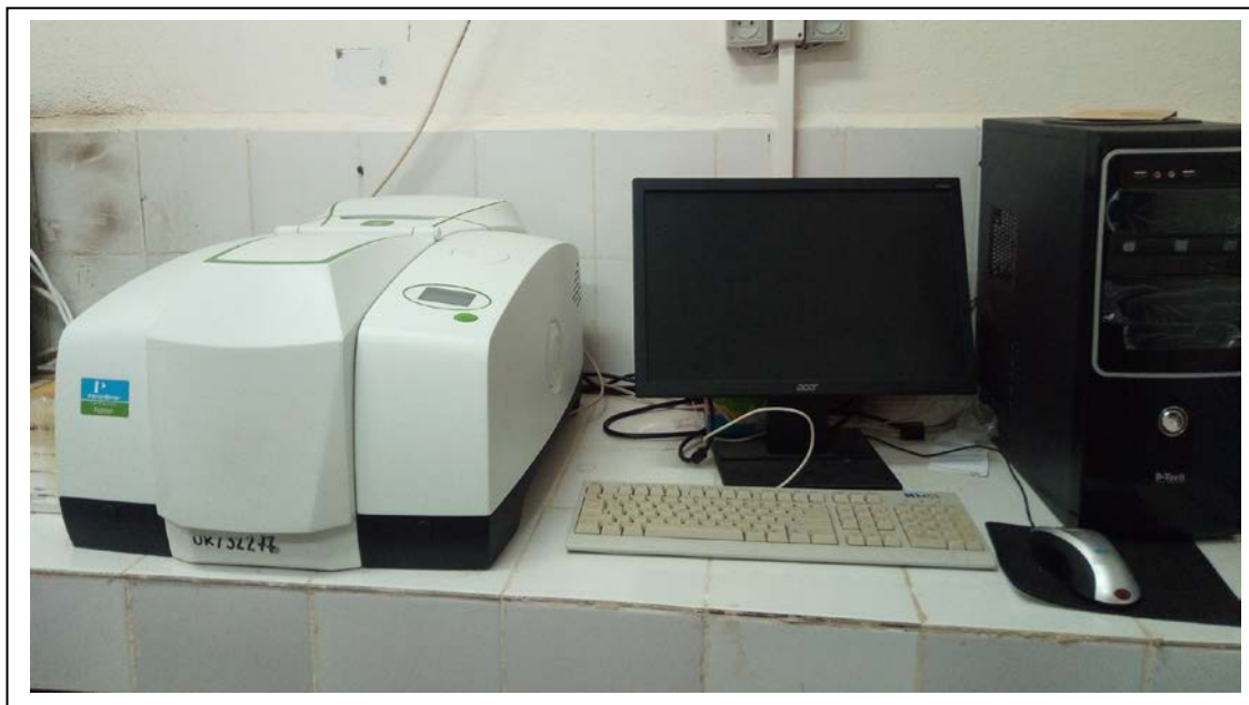
Figure II.6. Le spectromètre PerkinElmer FT-IR / spectromètre Frontier
