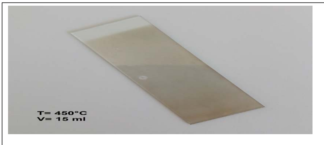
Figure II.2. Photo montre une couche mince de SnO 2 déposée sur substrat de verre par la technique USP.
