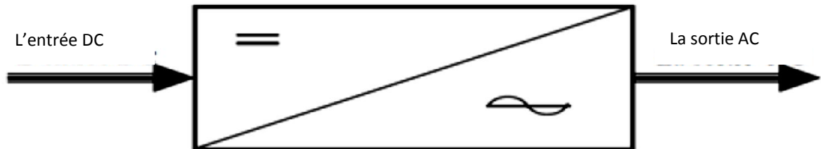
Figure 2.12 : le Schéma symbolique de l'onduleur [10].
