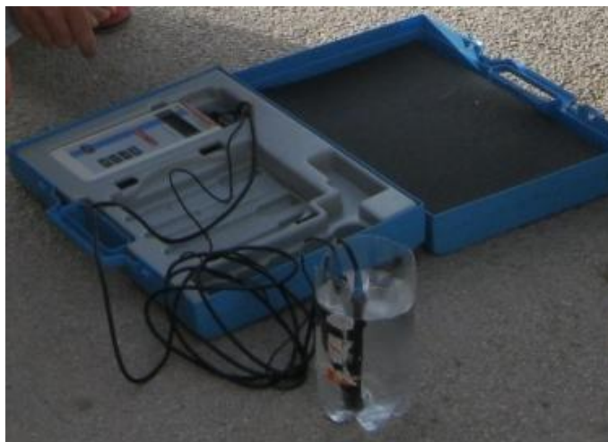
Figure II-25: mesure des paramètres physiques in situ (Ain ALKARMA)
