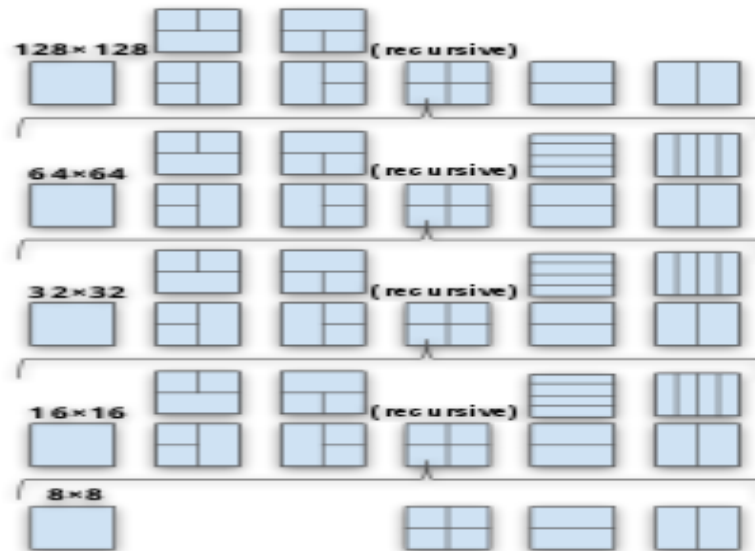
Figure III. 3. 3 Schéma du partitionnement du super bloc AV1.
