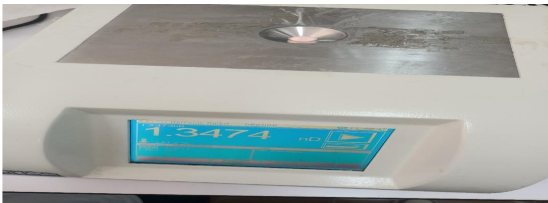
Figure 5 : Un réfractomètre (original)
