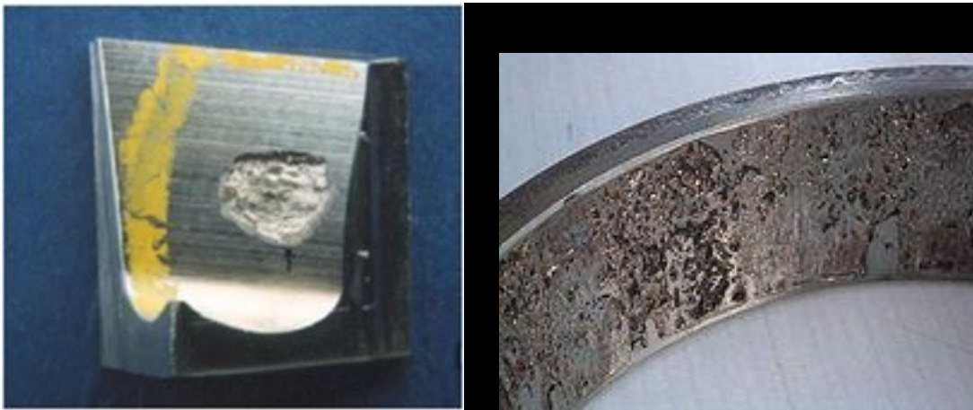
Figure 2.45 : exemple d'usure par fatigue
