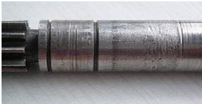
Figure2.43 : exemple d'usure par adhésion
