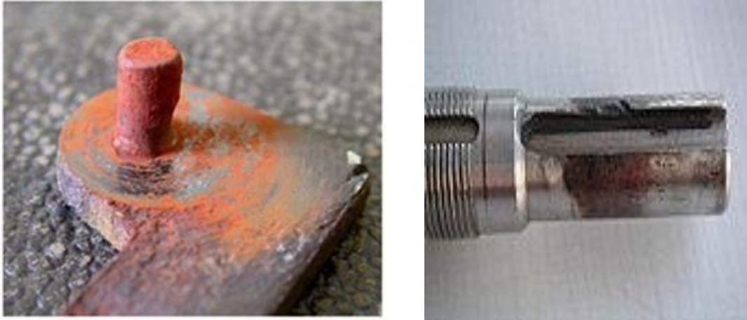
Figure 2.44 : exemple d'usure par corrosion
