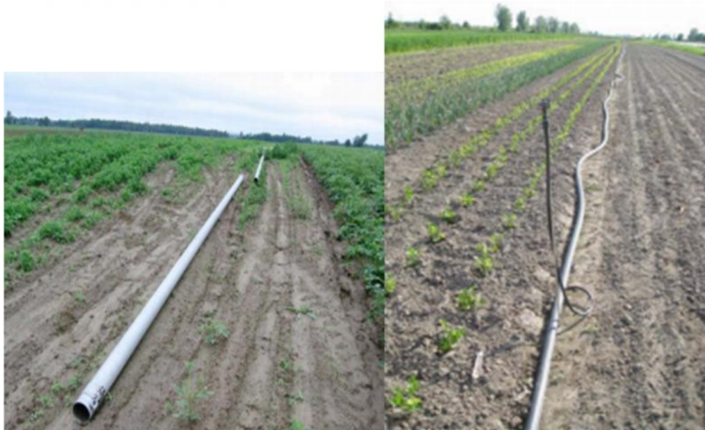
Figure 8 : Système de micro-aspersion et tuyaux en aluminium pour les systèmes habituels
