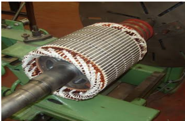
Fig.I.3: Rotor bobiné d'une MAS.
