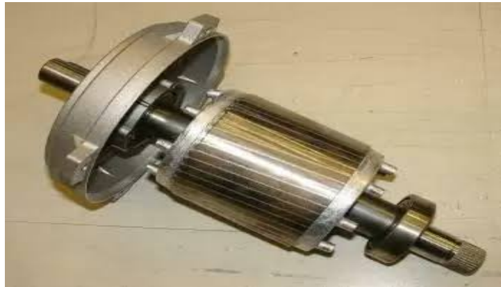
Fig.I.4: Rotor à cage d'une MAS.
