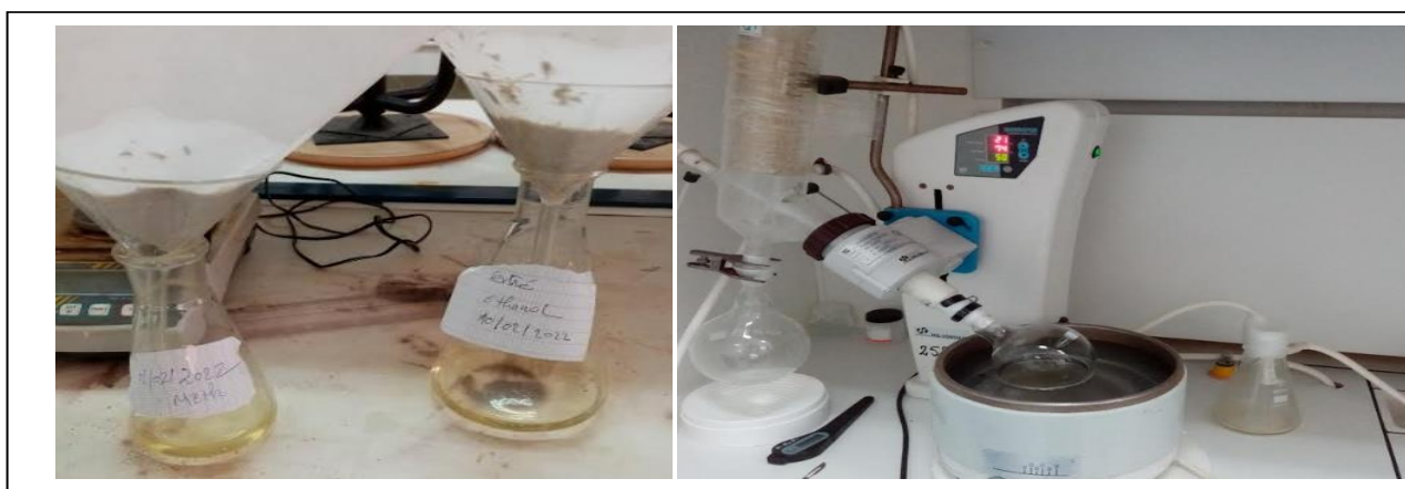
Figure30 : Filtration et évaporation
