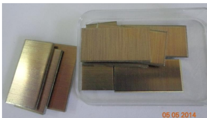
Figure III-6 : Echantillons oxydées 7 heures à 700°C (973 K).
