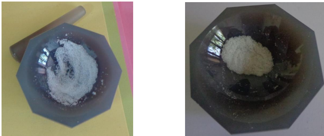
Figure III-8 : Mélange de l'oxyde gratté avec du KBr.
