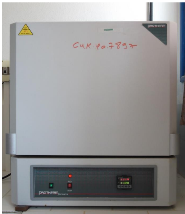
Figure III-4 : Four à moufle prothèrm.
