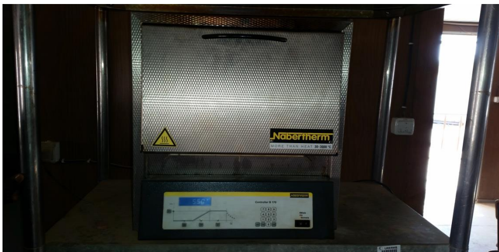
Figure 9. Four à moufle utilisé pour la calcination.
