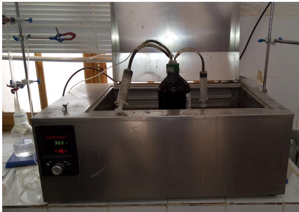
Figure 6. Le réacteur biologique placé dans un bain marie chauffé.
