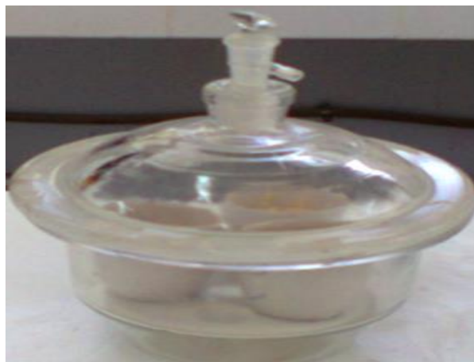
Figure 8. Refroidissement des capsules dans un dessiccateur
