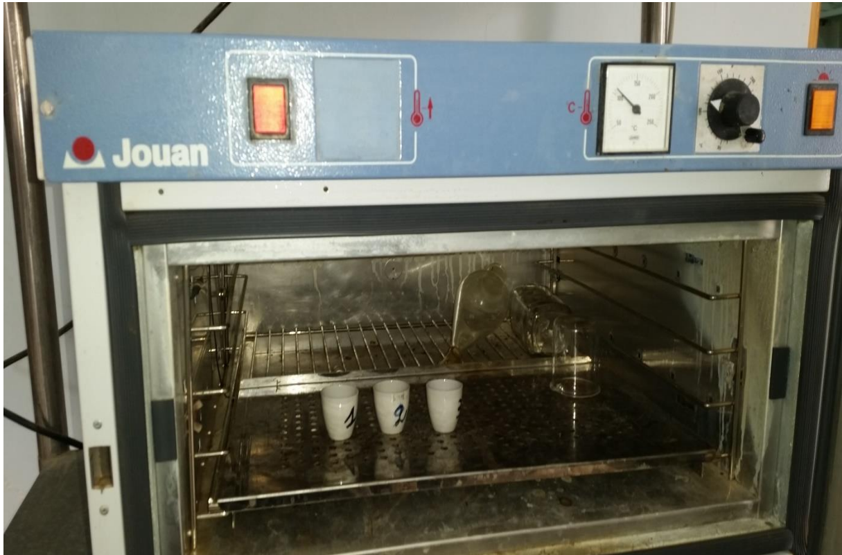
Figure 7. Capsules contenant de la boue pour séchage dans l'étuve.
