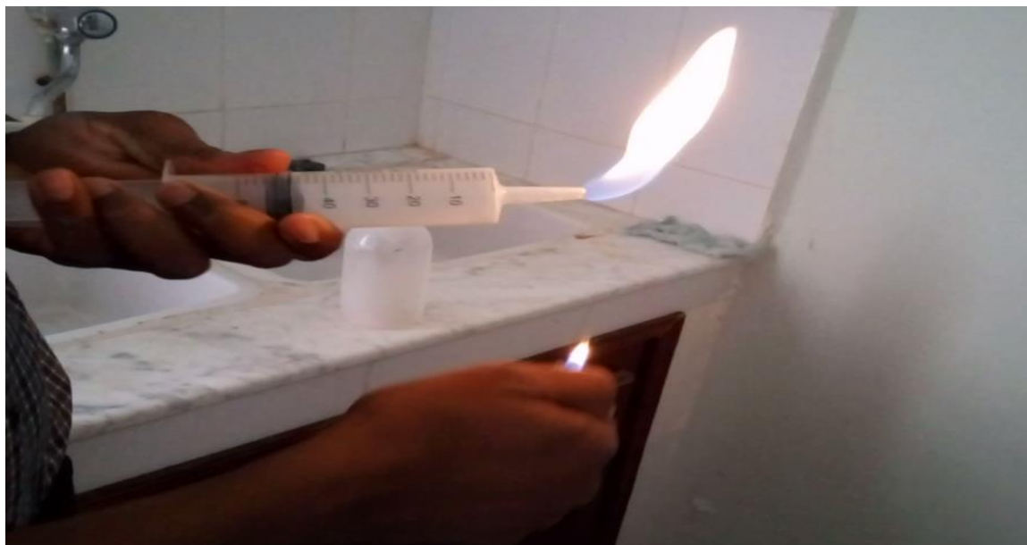
Figure 12. Test de l'inflammabilité du biogaz
