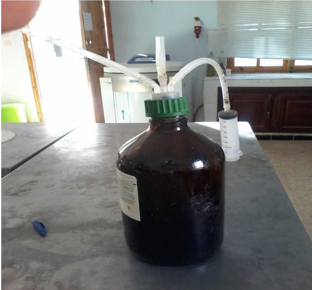
Figure 5. Montage utilisé comme réacteur biologique vide.
