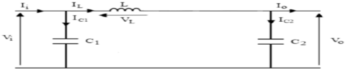
Figure 3-45 : Schéma électrique d'un hacheur boost ouvert. [15]
