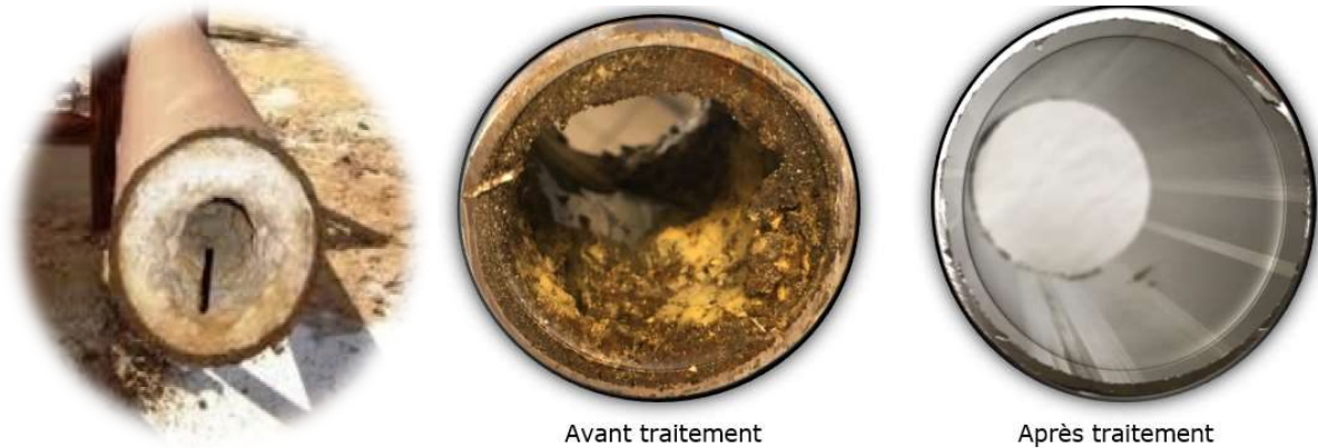
Figure II.11: Phénomène (avant et après) l'entartrage
