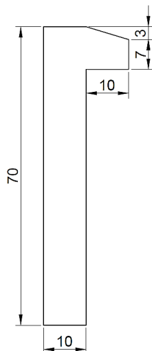
Figure II-2 : Schéma de l'acrotère.
