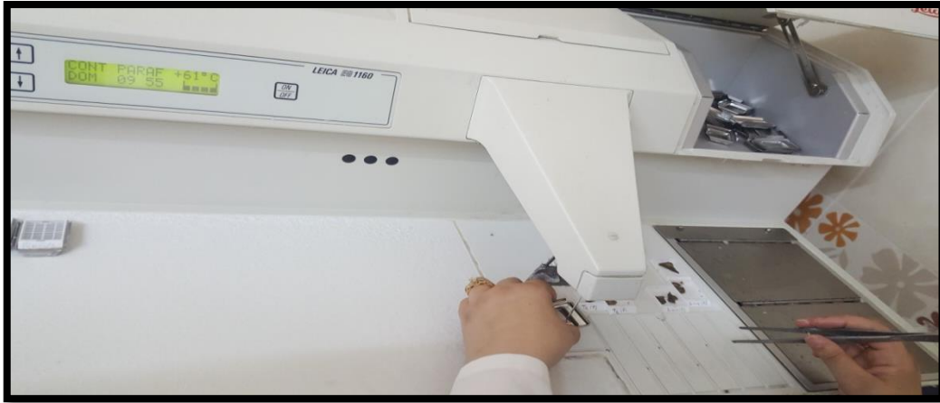
Photos 4 : Inclusion et réalisation des blocs par appareil compact d'enrobage (photo personnelle).
