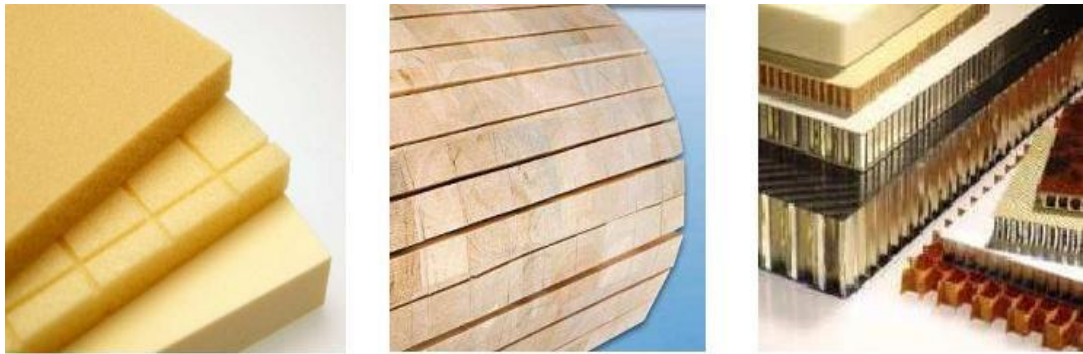
Figure (1.25): Exemples d'âmes les plus utilisées dans la construction des composites sandwichs : mousse, balsa bois, et nid d'abeilles [8]
