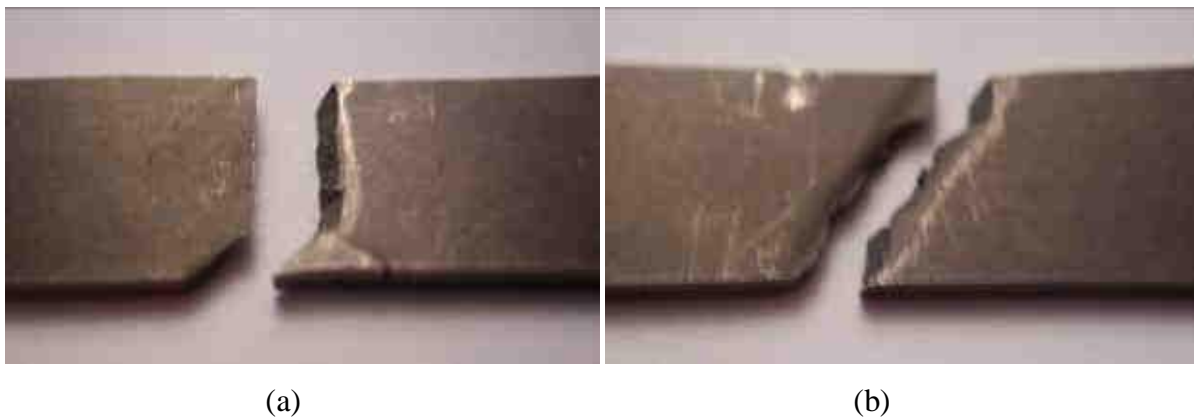
Figure (III.10) : Profils de rupture observés lors des essais de traction statiques.
