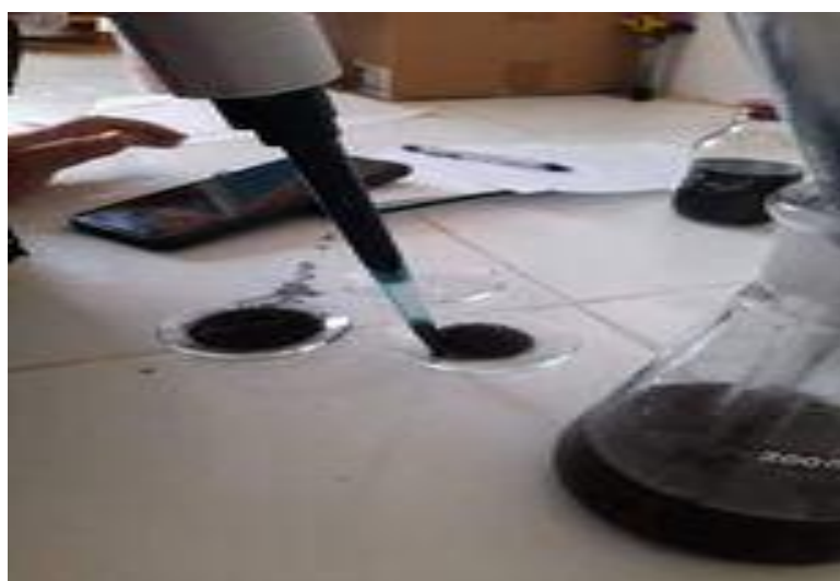
Figure III.10 : déposition manuellement des microgouttes directement sur la partie active de l'électrode (la méthode de drop coating)
