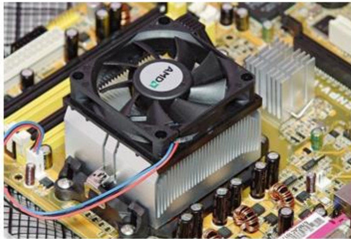
Figure III.4 : Un dissipateur de chaleur refroidi par ventilateur sur le processeur d'un ordinateur personnel. À droite, un dissipateur de chaleur plus petit refroidit un autre circuit intégré de la carte mère.
