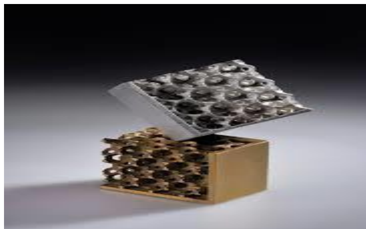
Figure (II.6) : Mousse métallique stochastique.
