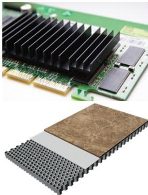
Figure III.17 : Exemple d'ailette de refroidissement et de nid d'abeille pour augmenter la surface d'échange convectif (ELECTROLUBE). [34]
