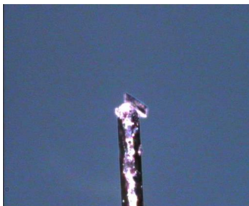
Figure59 : Cristal du composé (p-AAB) + , (HSeO 3 ) - collé sur le porte échantillon du diffractomètre.
