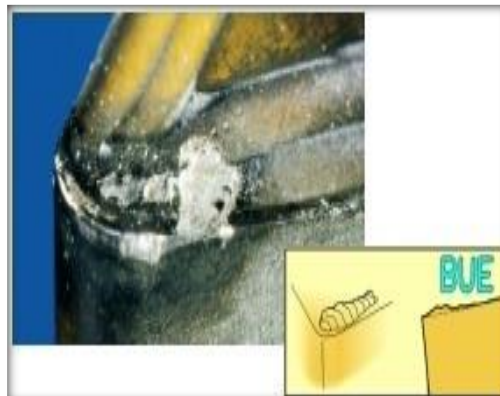
Figure II.32 : Usure par adhérence (Arête rapportée).
