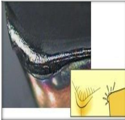
Figure II.33 : Usure thermique (déformation plastique)
