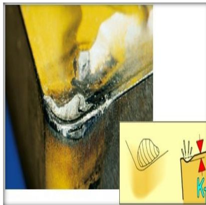
Figure II.30 : Usure en cratère (chimique).
