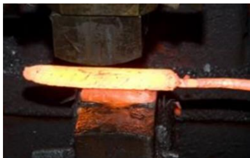
Figure I .16: Réalisation d'un brut en forge libre. Figure I .17: Pièces forgées [13].
