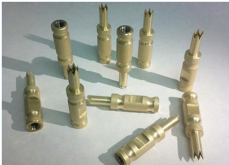
Figure I.13 : Poinçons revêtus d'une couche de nitrure de zirconium [47]
