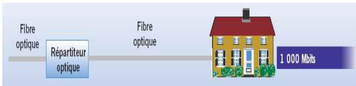
Figure 2. 6: La structure d'un réseau FTTH.
