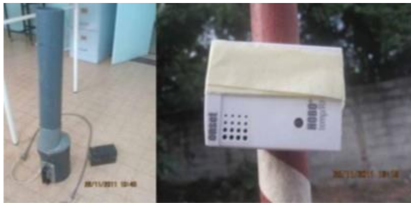
Figure 18 : Aspirateur avec batterie de 12volts à gauche et un enregistreur de température et d'humidité relative de type HOBO à droite (DUSSOM, 2012).
