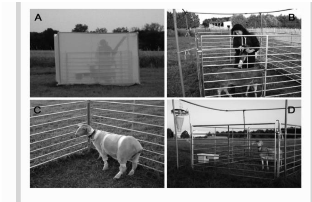
Figure19 : les quatre méthodes de collecte des culicoides (A) piège a goutte, (B) aspiration directe, (C) piège à couvercle collant et (D) piège a lumière UV/aspiration (OVI).
