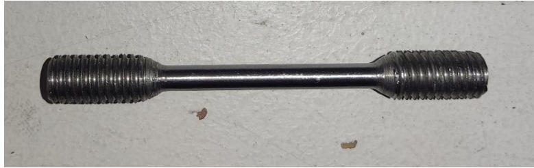
Figure III.7 : l'éprouvette réelle de la machine numérique.
