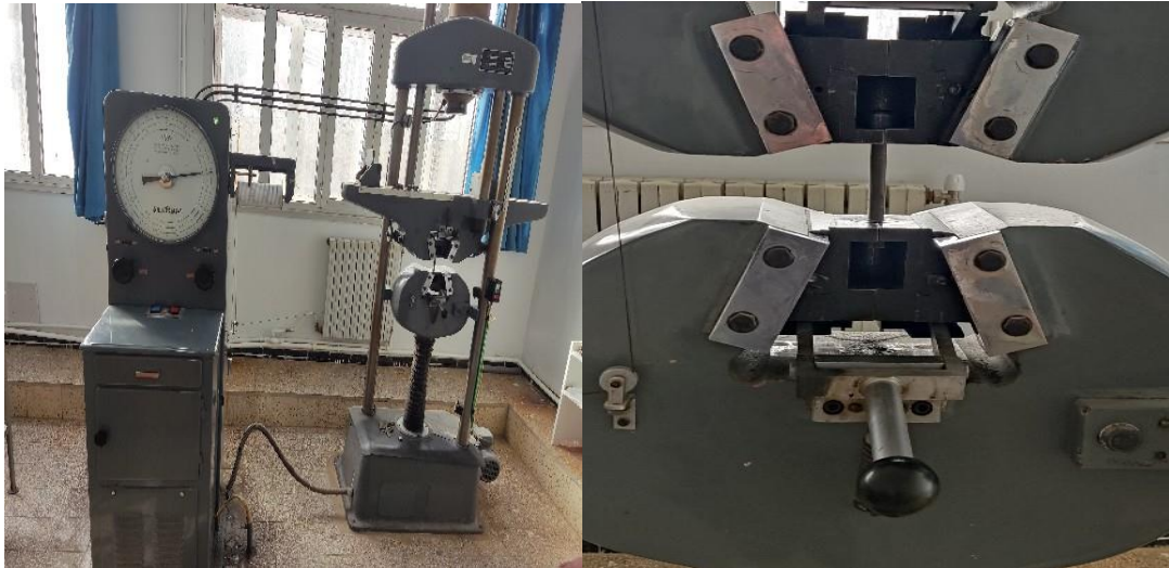
Figure III.14 : Machine de traction classique type de WE-30.
