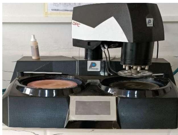
Figure III.11 : Polisseuse numérique type de Micapersi.
