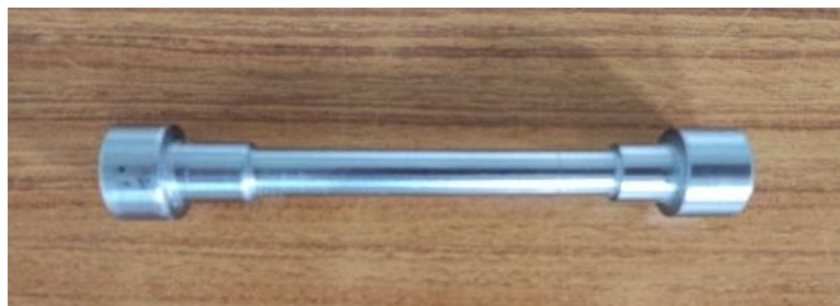
Figure III.5 : l'éprouvette réelle de la machine classique.
