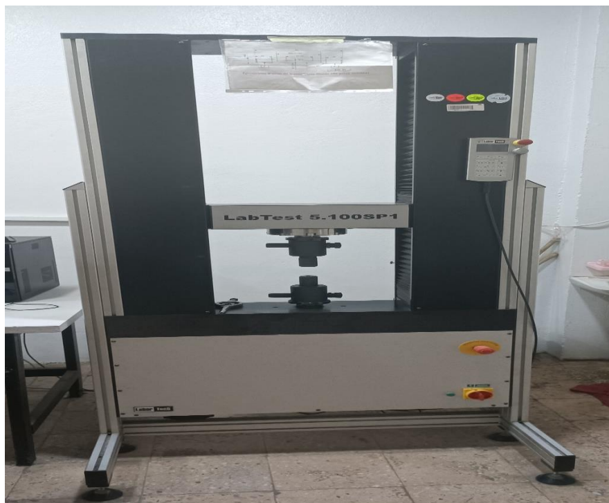
Figure III.15 : Machine de traction numérique.
