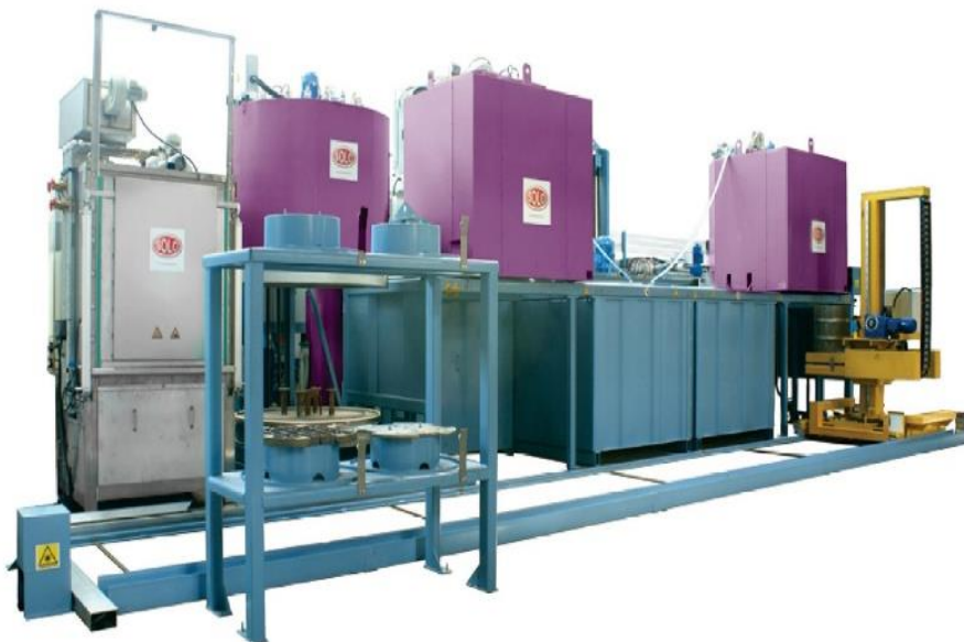
Figure III. 8 : chaine de traitement thermique SOLO.
