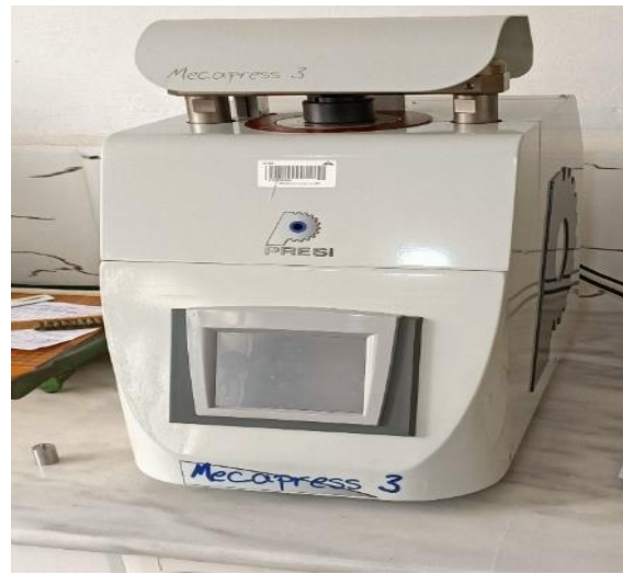
Figure III.10 : Enrobeuse type de micapress 3.
