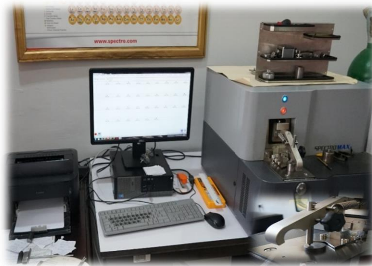
Figure III.1 : spectromètre Type de SPECTROMAX .
