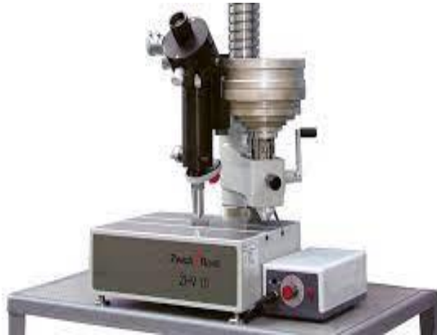
Figure III.13 : Appareil de mesure de la micro-dureté type de Zwick Roell, ZHV10.
