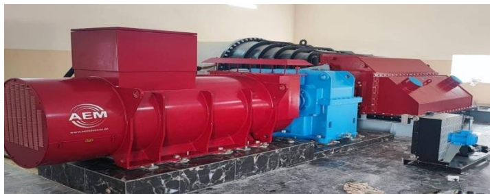
Figure 20 Présentation d'une turbine ORC (Quoilin S. e., 22/06/2012)
