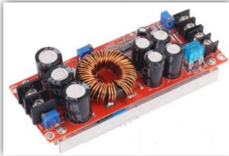
Figure III.12 : Convertisseur BOOST SZ-BT07CCCV
