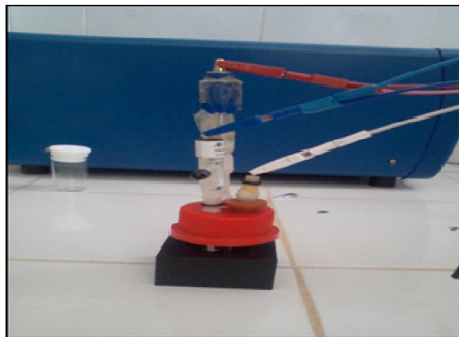
Figure 4-4: cellule électrochimique en verre à trois électrodes
