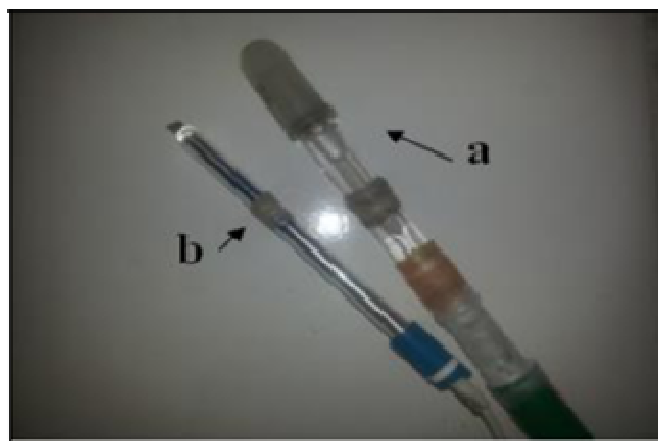
Figure 4-2 : Électrode de référence (a) et contre électrode (b).
