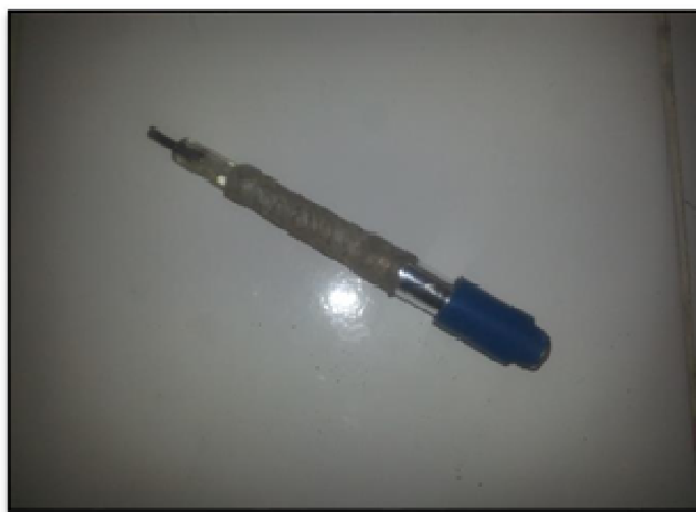
Figure 4-1 : Electrode de travail en Carbone vitreux.
