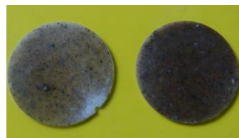
Pastille KBr sur le mortier
