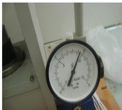
Cadran de lecture de la pression Indiquant ~10 t appliquée lors du pastillage
