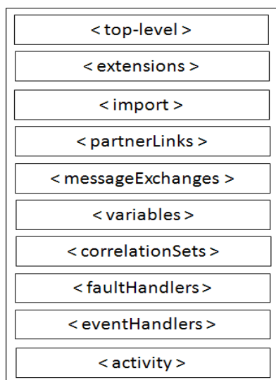
Figure I.4. Structure générale du processus métier en WS-BPEL
