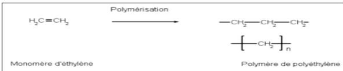
Figure III.11 : Schéma représentatif du motif du polyéthylène.
