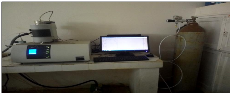
Figure III.17: photo d'un appareil DSC/ATG (NETZSCH).
