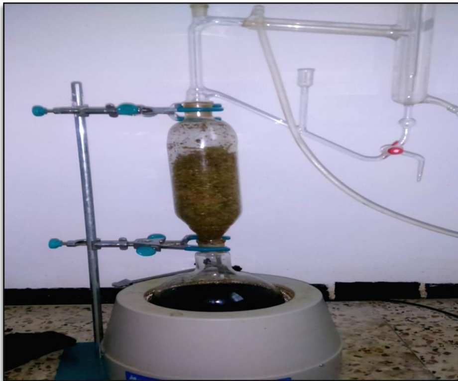
Figure 02 : Dispositif d'extraction Clevenger
