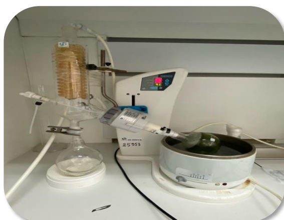
Obtention d'extrait méthanoliques par évaporation dans un évaporateur rotatif sous pression réduite à 40 °C
