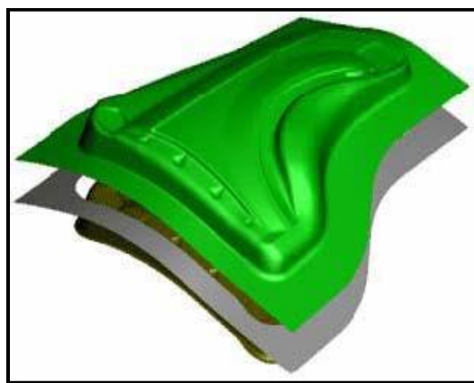
Figure I.8. Outils d'emboutissage d'aile d'une voiture (Documentation STAMPACK, Société QUANTECH). [4].
