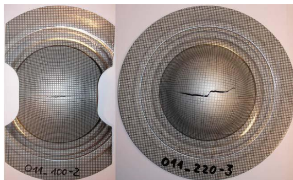
Figure I.24: Mise en évidence par l'essai Nakazima d'une rupture après striction localisée (à Gauche : en rétreint) et sans striction localisée (à droite : en expansion). [23]
