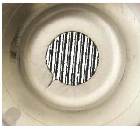
Figure I.25: Essai d'expansion d'une tôle en acier doux ayant un trou au centre. Apparition de plusieurs bandes de localisation au bord du trou, avec propagation d'une fissure macroscopique selon la direction radiale (3ème Rapport CECA, VoestAlpine). [23]
