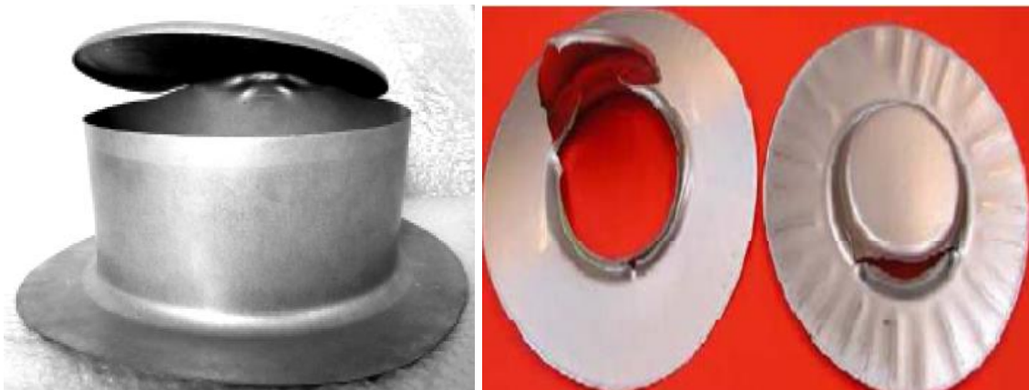
Figure I.26: Rupture sans formation de plis (à gauche : effort de serrage élevé) et avec formation de plis (à droite : effort de serrage faible). D'après Lang et al. (2004).
