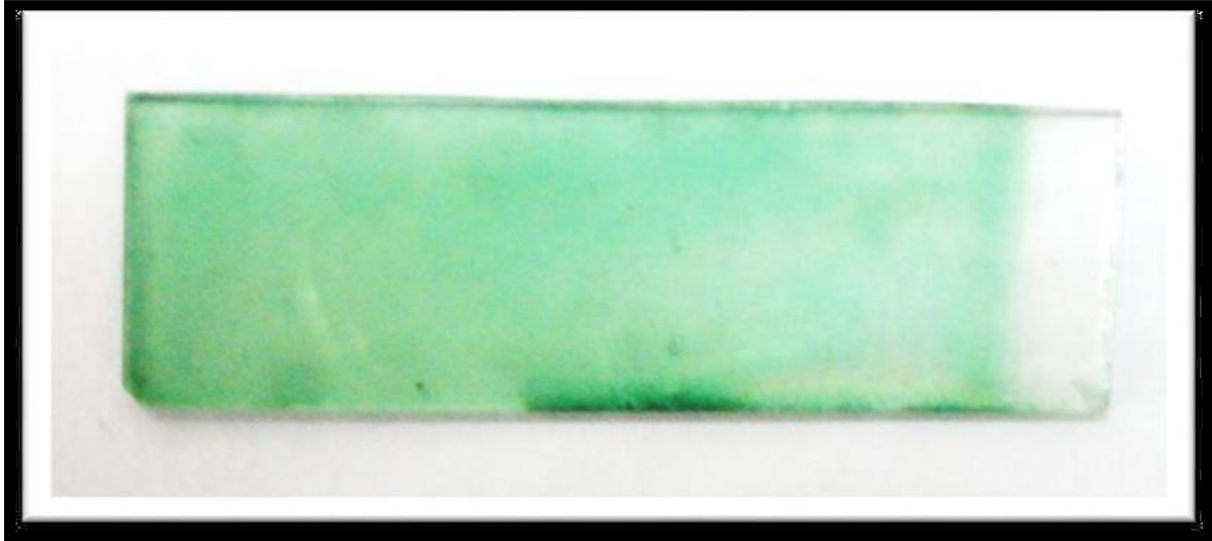
Figure II.3: Photos montrant des couches minces de Zn_{(1-x)}Co_xO déposées sur substrat de verre par la technique USP. [1].
