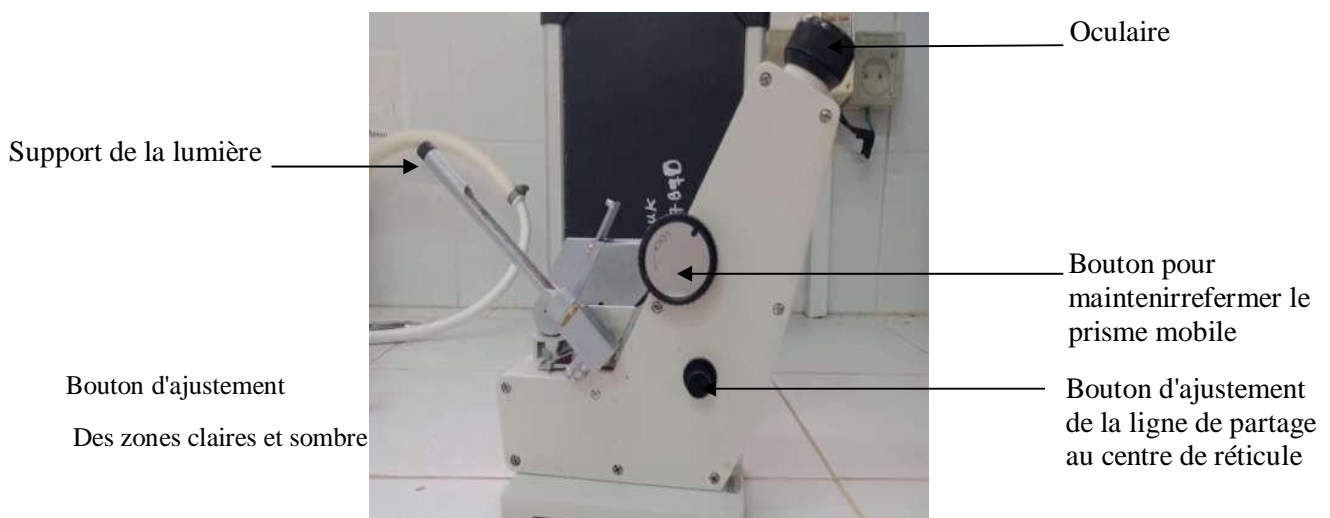
Figure 32: Réfractomètre utilisé pour l'analyse.
