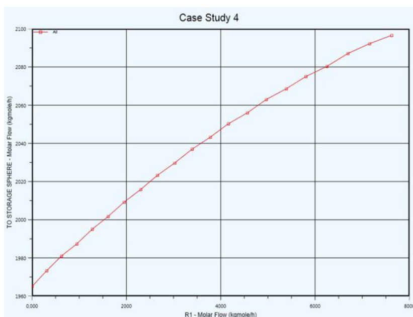
Figure IV.1: Débit de GPL expédié en fonction de recyclage du gaz sec.
